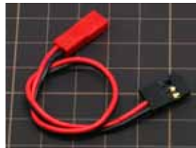
0019-08 変換コネクタ (BECメス-フタバオス) 受信機からファン等電源を取る場合の変換コネクタ。
