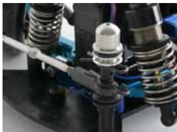
使用例。ヘッドは5mm仕様のボディポストにボディピンで固定します。
