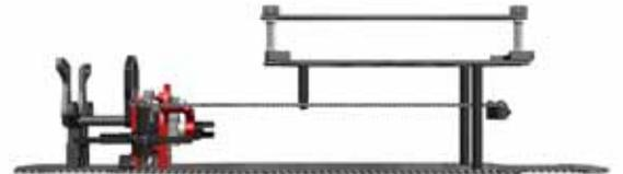
シャーシ面より60mm上部に配置されたロングリボ対応のバッテリープレート。アッパーデッキとメインシャーシ3点のポストで支持し、バッテリーをがっちりホルド。バッテリープレートはサービスホールを多く設け、汎用のポスト等で組み合わせれば多彩な搭載方法を選べます。
