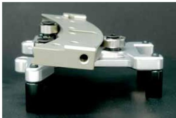
VX-DOCK2 用オプションパーツ。スライドレールの軌道を3次元化し、バンプ変化を最小限に抑えます。本製品はレールの3次元軌道を生む為にレールを支持する前後のベアリングに高低差をつける物で、レールを傾斜させた際に、レールとネジの頭が接触するのを回避するベアリングとカラーのセットになります。
